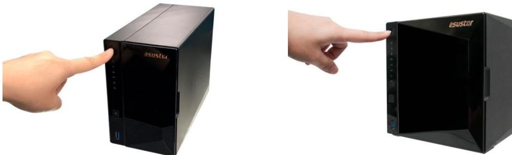
4. Der NAS ist betriebsbereit, sobald die grüne Systemstatus-LED nicht mehr blinkt, sondern dauerhaft leuchtet. Dabei sollten Sie einen Signalton hören. Die Hardwareinstallation ist nun abgeschlossen. Lesen Sie zur Konfiguration der Systemeinstellungen nun die Softwareinstallationsanleitung.
