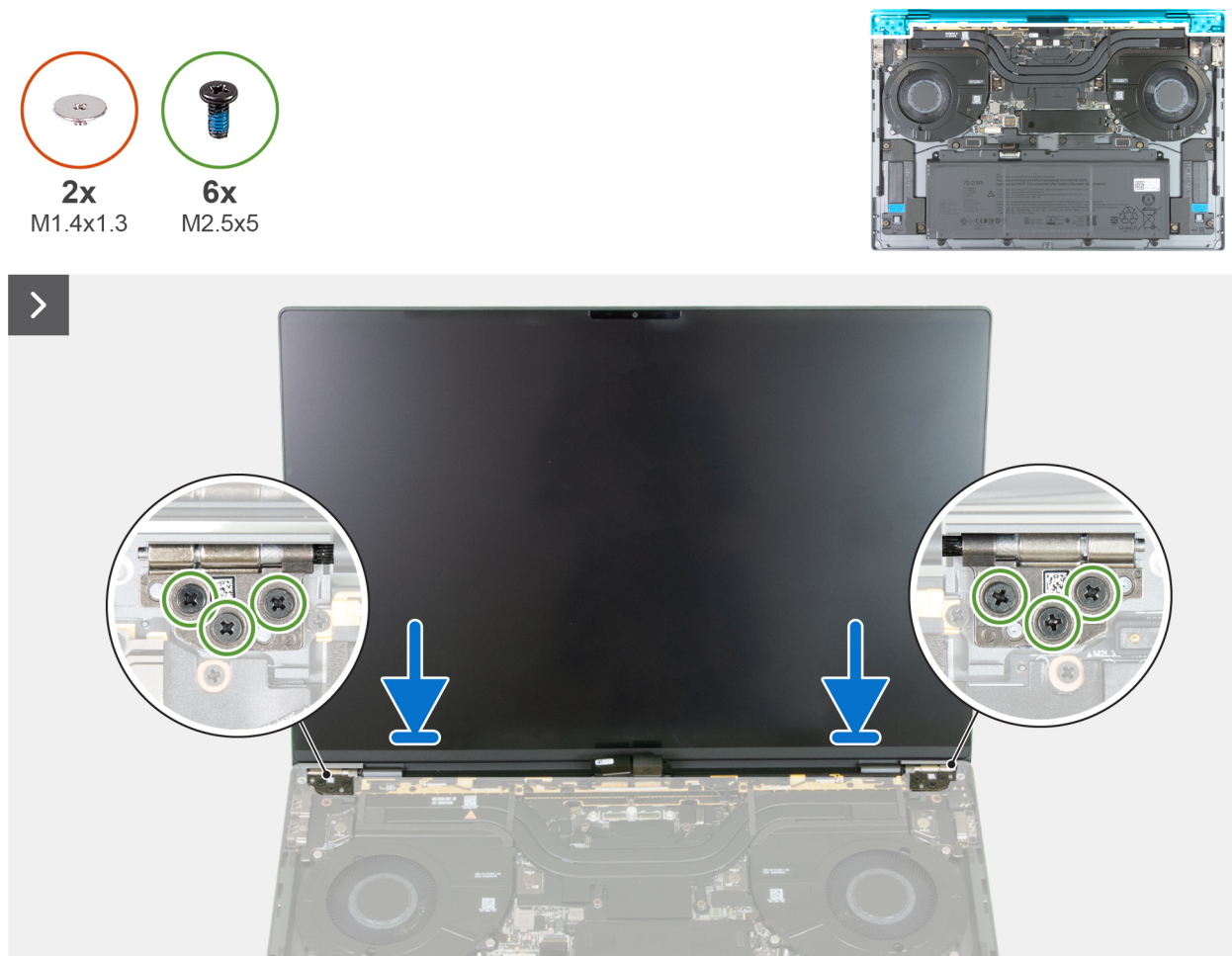
Abbildung 19. Einbauen der Bildschirmbaugruppe
