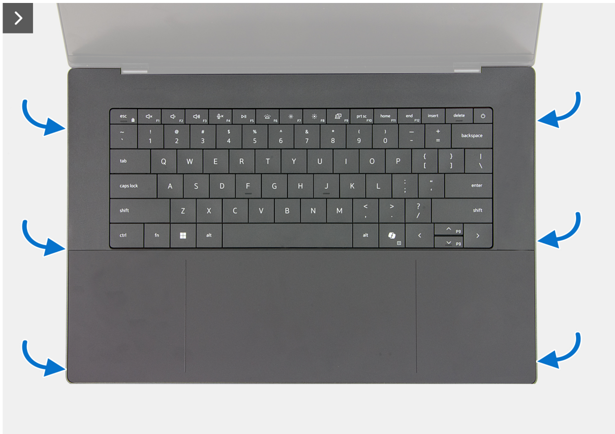
Abbildung 3. Lösen Sie die Handballenstützen- und Tastaturbaugruppe von der Bodenabdeckung
