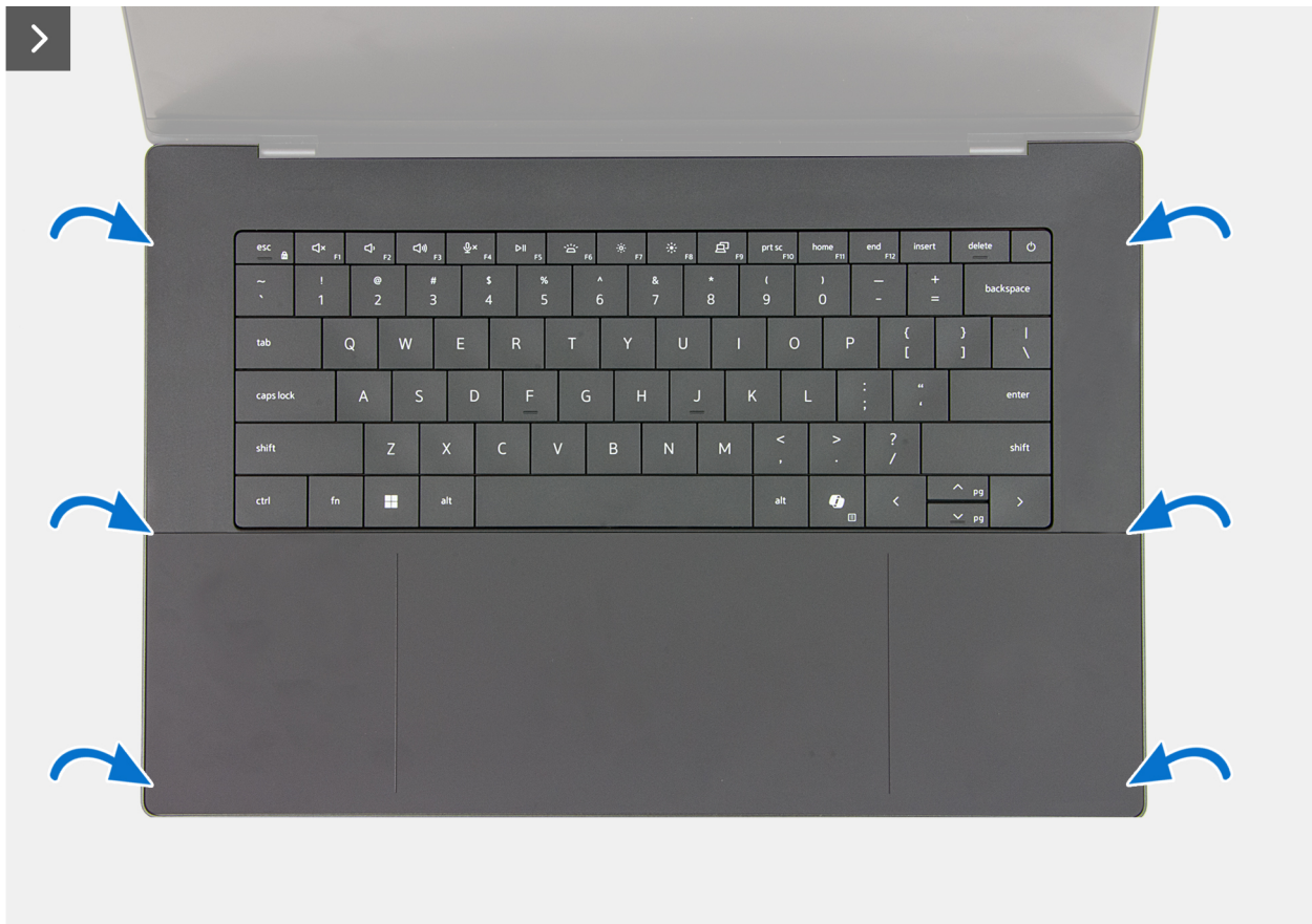
Abbildung 7. Richten Sie die Handballenstützen- und Tastaturbaugruppe aus und lassen Sie sie auf der Bodenabdeckung einrasten
