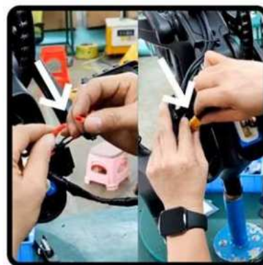
6. Die Stromkabel wieder anschließen.
