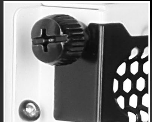
Werkzeugfreie Montage von Erweiterungskarten durch Rändelschrauben
