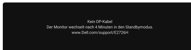
Abbildung 38. Warnmeldung: DP-Kabel nicht angeschlossen
