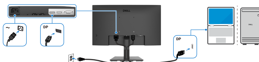
Abbildung 16. Anschließen des DP-Kabels
