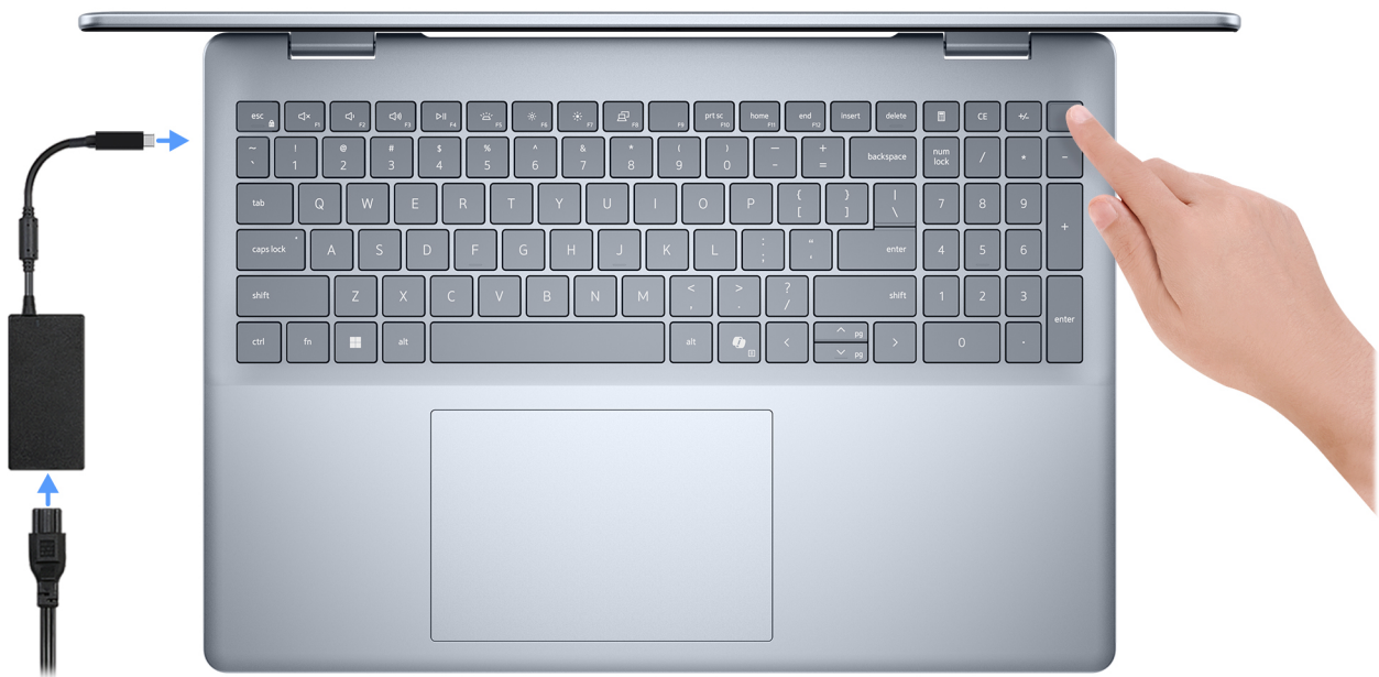
Abbildung 7. Schließen Sie das Netzteil an und drücken Sie den Betriebsschalter.
