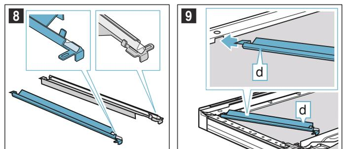
8. Reflektor **d** einsetzen (Bild **10**).
