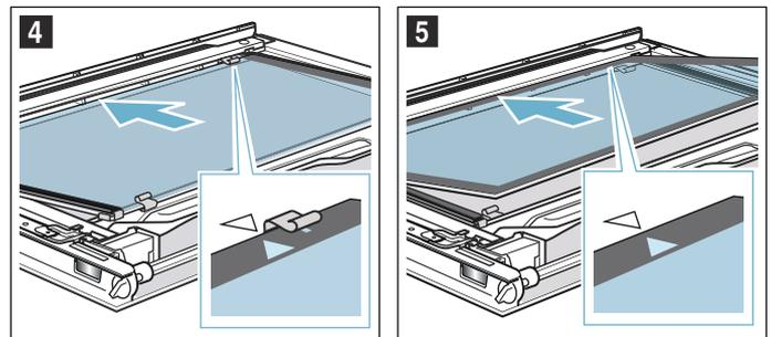
5. Zwischenscheibe im Bereich **b** nach unten drücken, Halterung **c** schräg einschieben und andrücken, bis sie einrastet (Bild 6). Halterung ist eingesetzt (Bild 7).
