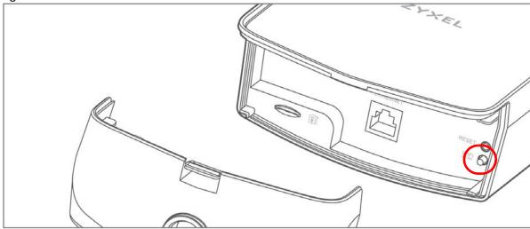
Figure 11 LTE7461-M602 / LTE7480-M804 / LTE7480-S905 / LTE7490-M904 WiFi Button
