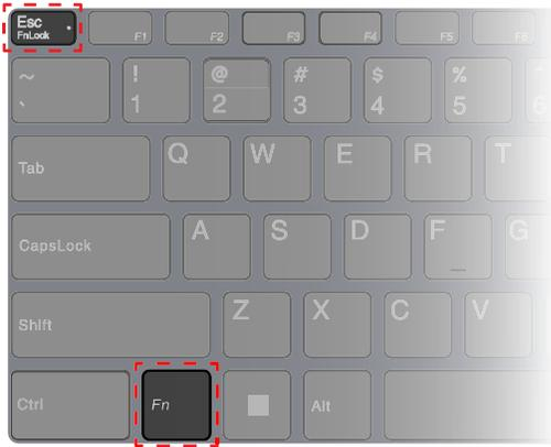
Abbildung 9. Positionen der FnLock-Taste und der Fn-Taste
