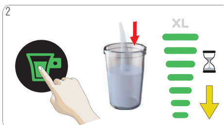
Um das Abkühlen zu beschleunigen, Stufe 7 auf der Leuchtbalkenanzeige wählen. Start/Stop-Symbol antippen. Die Maschine beginnt zu spülen. Die Leuchtbalken erlöschen der Reihe nach.
