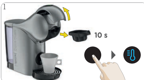
Arretierungsbügel öffnen. Maschine schaltet sich automatisch ein. Innerhalb von 10 Sekunden nach dem Einschalten der Maschine Symbol für die Temperatúrauswahl antippen, um in den KALT-Modus (blau) zu wechseln. Es kann nun sofort ein kaltes Getränk zubereitet werden.
