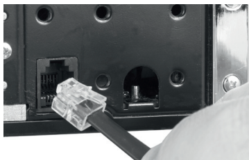
Abbildung 3 - Verbinden der Drehregler mit dem Radiogerät
