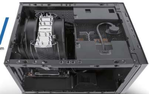
CPU-Kühler bläst nach unten 3,5" HDD x 2, 2,5" SSD x 3
