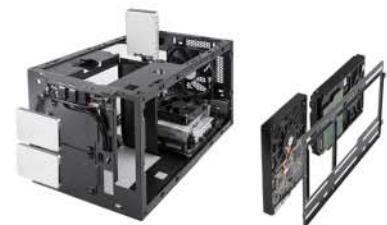
Tower-Luftkühler 3,5" HDD + 2,5" SSD x 3 *3,5-Zoll-Gerät ist auch mit 120-mm-/140-mm-Lüfter kompatibel
