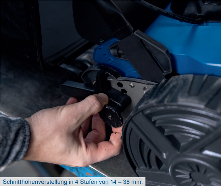
Schnitthöhenverstellung in 4 Stufen von 14 – 38 mm.
