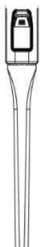
Strumento per fessure
