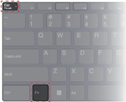
Abbildung 2. Positionen der FnLock-Taste und der Fn-Taste
