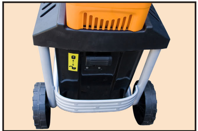
Verriegelungsgriff des Fangkorbes mit integrierter Sicherheitsabschaltung
