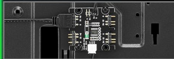
4-fach RGB-Steuerung für adressierbare LEDs
