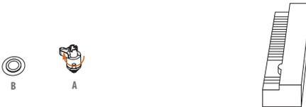
Ziehen Sie die gelbe Schutzfolie von der Mutter A ab. Entfernen Sie dann die Sperrmutter mit einem Schraubendreher und ziehen Sie sie an Mutter A fest.
