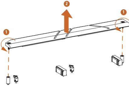
Vor der Installation einer M.2-SSD-Karte lösen Sie bitte die Schrauben, mit denen der M.2-Kühlkörper befestigt ist.
