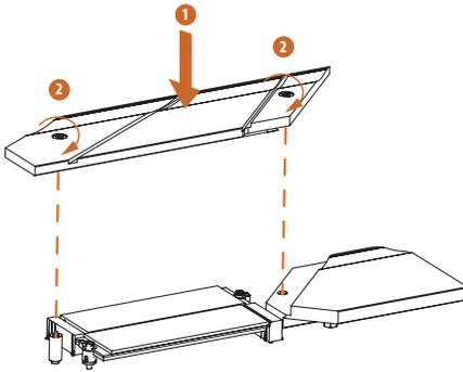
Fixieren Sie den M.2-Kühlkörper, indem Sie die Schrauben mit einem Schraubendreher anziehen. Bitte ziehen Sie die Schraube nicht zu fest an, da dies den M.2-Kühlkörper beschädigen könnte.
