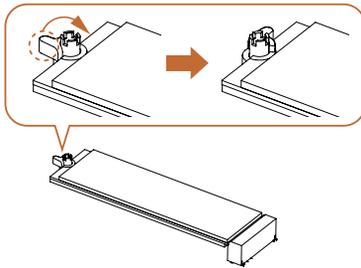
Stellen Sie sicher, dass die Kerbe am Ende der M.2-SSD-Karte an der Mutter ausgerichtet ist. Sichern Sie dann die M.2-SSD-Karte, indem Sie die Mutter im Uhrzeigersinn in die Sperrposition drehen.
