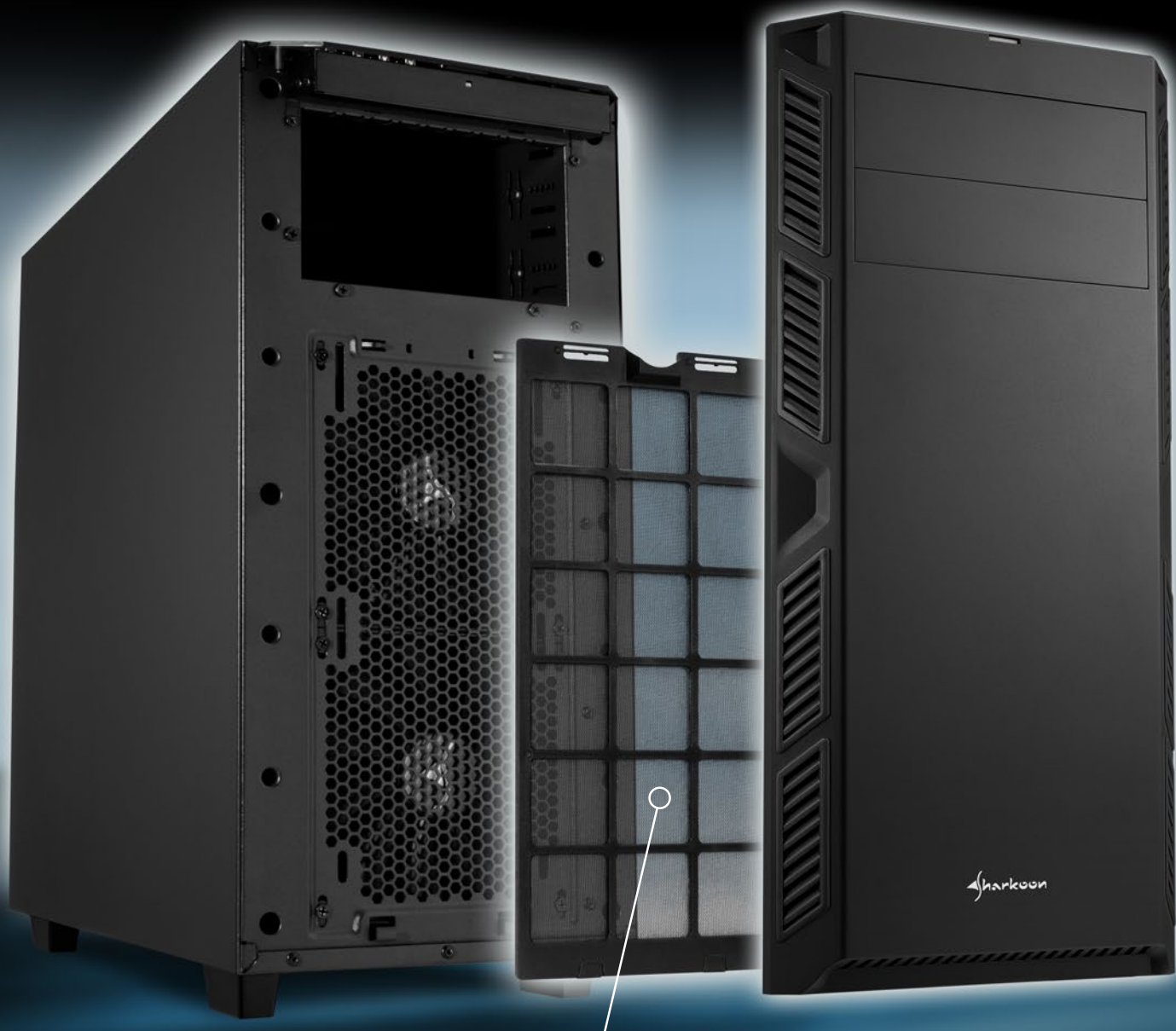
Abnehmbarer Staubfilter in der Gehäusefront
