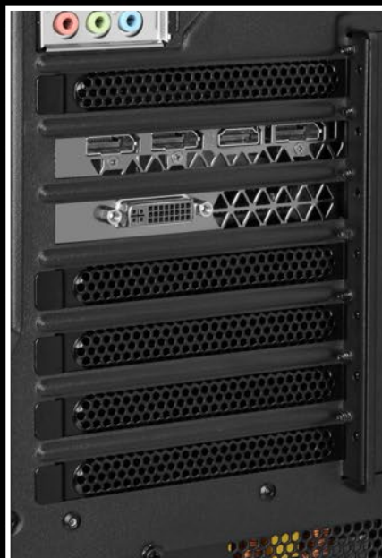
Mesh-Slotblenden zur besseren Luftzirkulation
