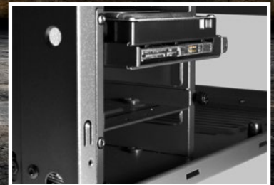
Entkoppelte Montage von bis zu drei 3,5-Zoll-Festplatten im Tunnel
