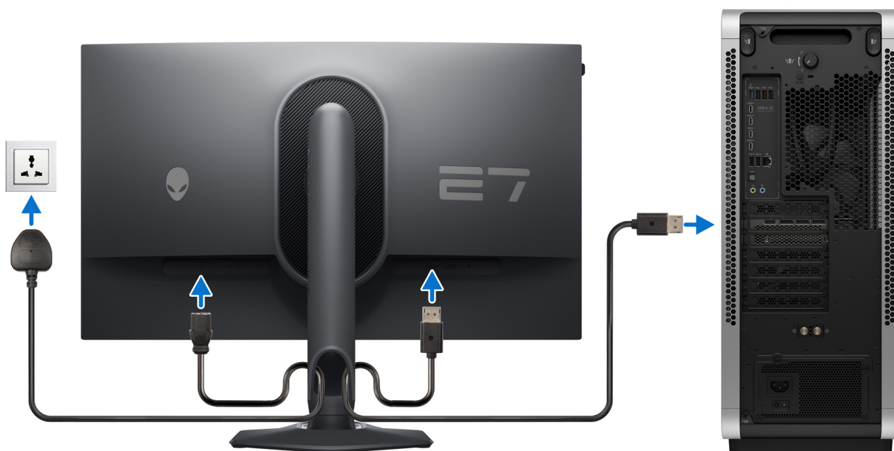
Abbildung 15. Anschließen des Displays
