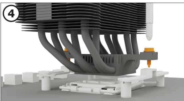
Entferne zunächst den magnetischen Deckel. Lege dann den Kühler mittig auf die Intel Montagebrücken, sodass sich der Kühler mit selbigen verschrauben lässt. Hierzu kannst du den Kreuzschraubendreher verwenden.
