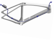
Kabelverlegung – eTap: Anleitung
