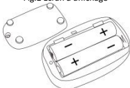
Fig. 3 Installation des piles
