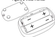
Figura 3 Colocación de baterías
