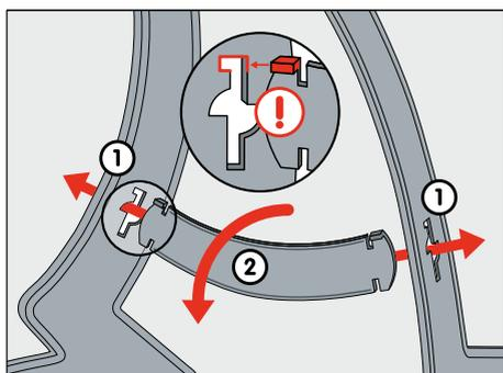
Um den Drehständer aufzubauen, steckt ihr die Enden des kleinen Bogens in die dafür vorgesehenen Schlitzte der beiden großen bogenförmigen FüÙe. Dreht den kleinen Bogen in die richtige Position fest.
