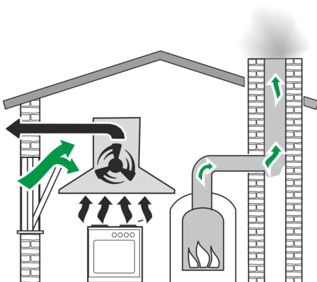
Abb. 36: Verwendung eines Fensterkippeschalters
