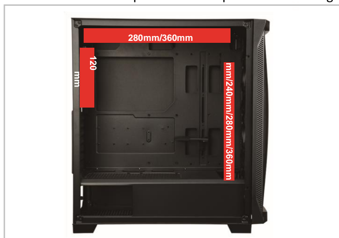
Installation von insgesamt zwei 360-mm-Radiatoren oben und vorne
