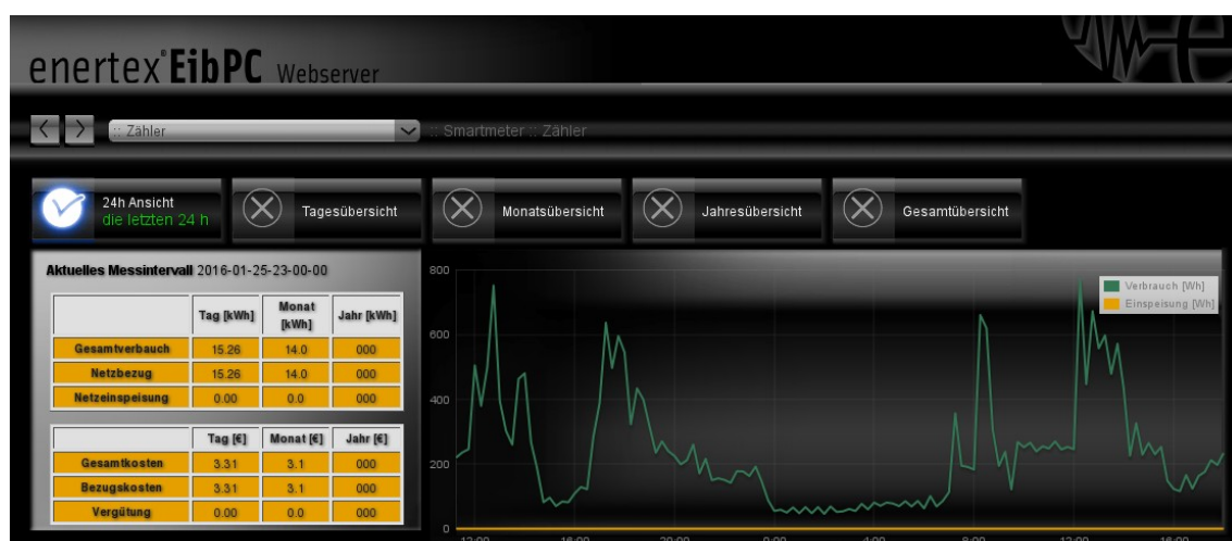
Abbildung 3: Beispiel für die Visualisierung eines Energieverbrauchs
