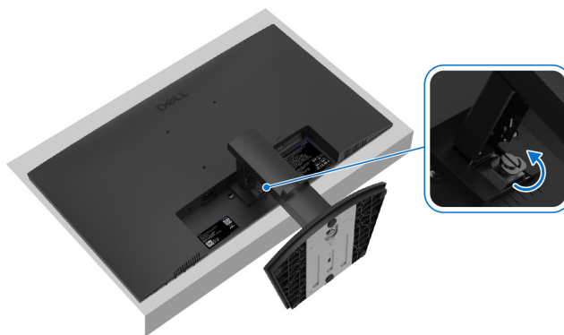
Abbildung 16. Rändelschraube gegen den Uhrzeigersinn lösen
