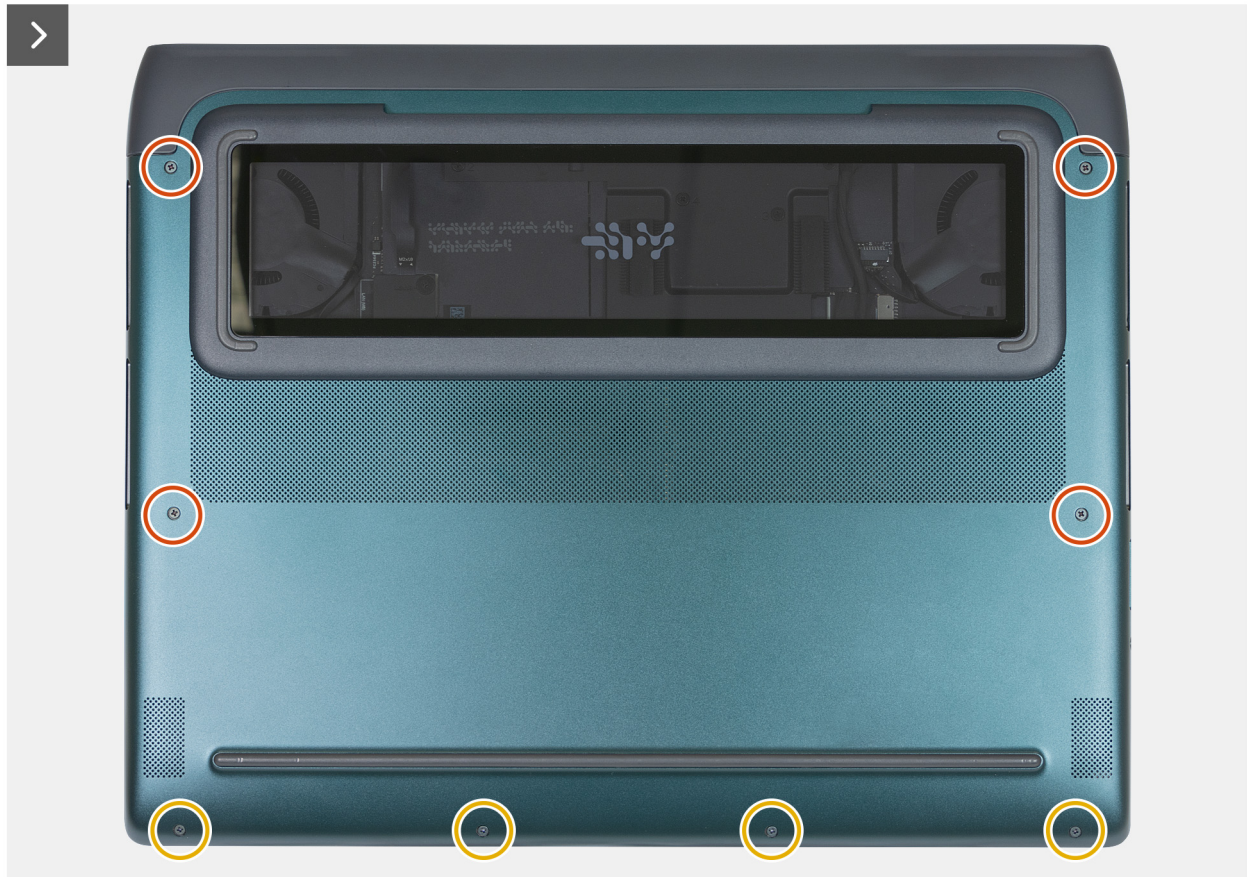
Abbildung 10. Entfernen der Schrauben für die Bodenabdeckung
