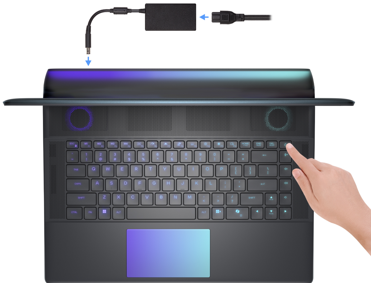
Abbildung 6. Anschließen des Netzteils und Drücken des Netzschalters
