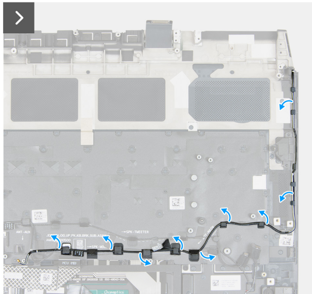
Abbildung 73. Entfernen der WLAN-Hauptantenne
