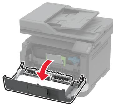
**4** Entfernen Sie die Belichtungseinheit.
