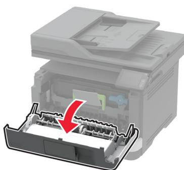
**2** Entfernen Sie die gebrauchte Belichtungseinheit.
