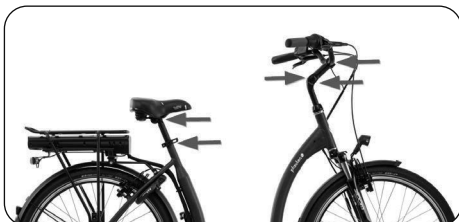
Mögliche Positionen von Schraubverbindungen/Schnellspanner zur Anpassung beim Fena FM
