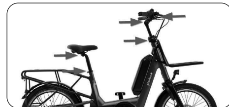
Mögliche Positionen von Schraubverbindungen/Schnellspanner zur Anpassung beim Smoo
