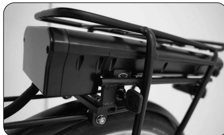
Akkuschloss beim Fena FM entriegeln
