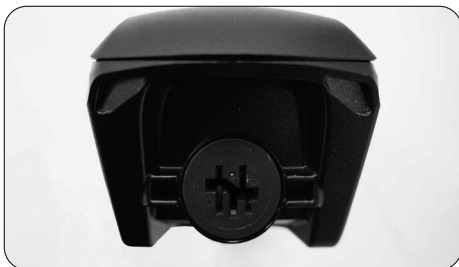
Ladebuchse am ausgebauten Smoo Akku
