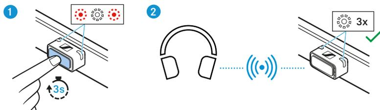
Sobald der Dongle mit einem Bluetooth-Kopfhörer gekoppelt ist, blinken die Status-LEDs am Dongle-Gehäuse dreimal weiß.
