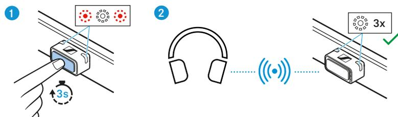
Sobald der Dongle mit einem Bluetooth-Kopfhörer gekoppelt ist, blinken die Status-LEDs am Dongle-Gehäuse dreimal weiß.
