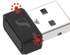
Die beiden Status-LEDs am Dongle-Gehäuse zeigen den Betriebszustand des Dongles an:
