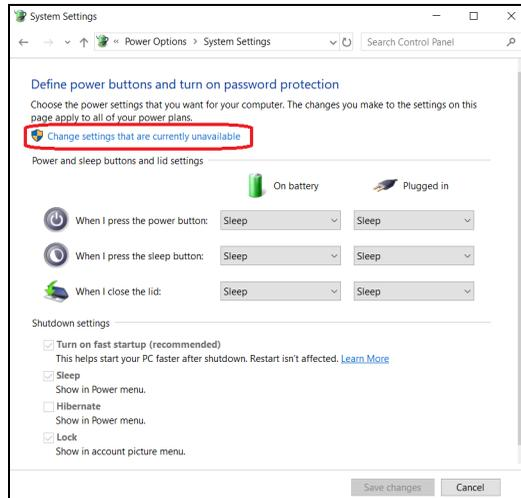
5. Scrollen Sie nach unten und deaktivieren Sie die Option **[Turn on fast startup]** **[Schnellstart aktivieren]**.
