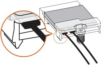
Stellen Sie sicher, dass das WLAN-Modul sicher von der schützenden Kunststoffabdeckung gehalten wird.
