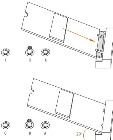
Setzen Sie das M.2-SSD-Modul sorgfältig an den M.2-Steckplatz an, schieben Sie das Modul vorsichtig ein. Bitte beachten Sie, dass das M.2-SSD-Modul nur richtig herum in den Steckplatz passt.
