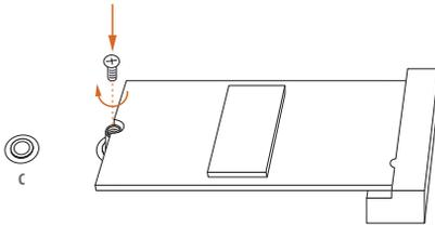
Fixieren Sie das Modul, indem Sie die Schraube mit einem Schraubendreher anziehen. Ziehen Sie die Schraube nicht übermäßig stark an; andernfalls kann das Modul beschädigt werden. Überspringen Sie Schritt 6, wenn Ihr M.2-SSD-Modul vom Typ 2280 ist.
