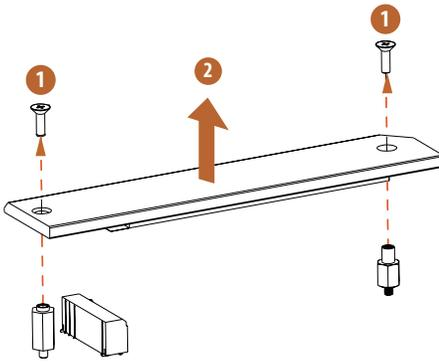
Vor der Installation eines M.2-SSD-Moduls lösen Sie bitte die Schrauben, mit denen der M.2-Kühlkörper befestigt ist.
