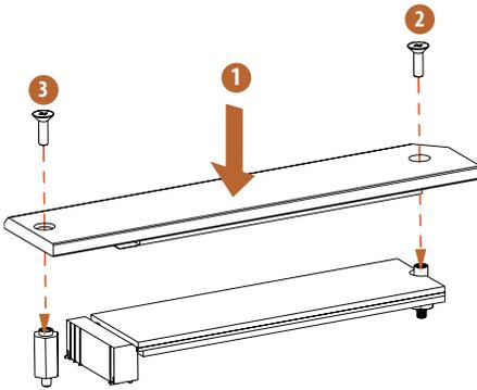
Ziehen Sie die Schrauben mit einem Schraubendreher an, um das Modul (wenn Ihr M.2-SSD-Modul vom Typ 2280 ist) und den M.2-Kühlkörper in der angegebenen Reihenfolge zu befestigen. Ziehen Sie zuerst die Schraube gegenüber dem M.2-Anschluss (2) und dann die Schraube neben dem M.2-Anschluss (3) fest. \*Ziehen Sie die Schraube bitte nicht übermäßig fest an, andernfalls können das Modul und der M.2-Kühlkörper beschädigt werden.
