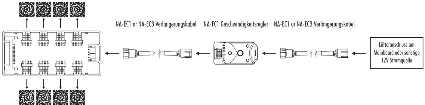
**Anwendungsbeispiel 4: Stromversorgung von 12V PWM-Lüftern mit hohem Stromverbrauch über den S-ATA-Anschluss und deren Steuerung mit NA-FC1 (54W max.)**
