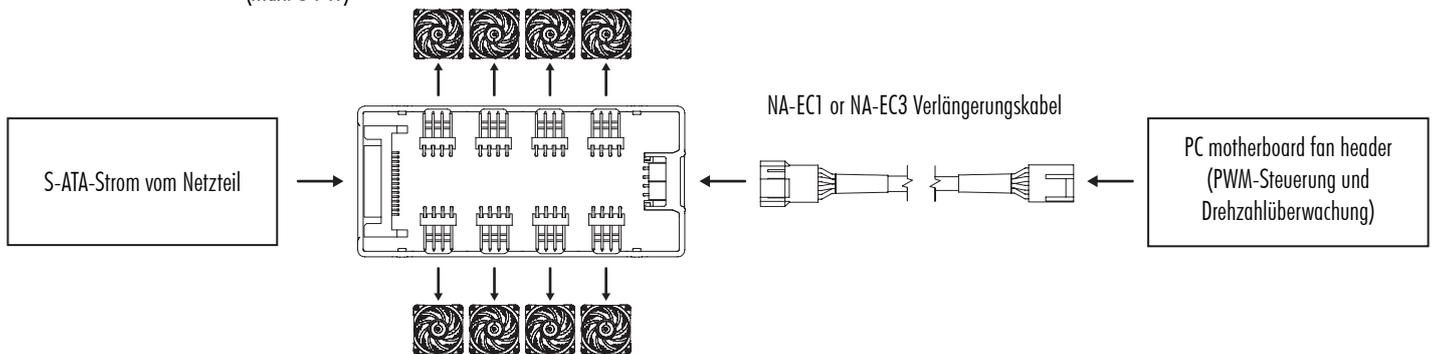
Sind sowohl der S-ATA als auch der 4-Pin Eingang angeschlossen, versorgt sich der NA-FH1 automatisch über S-ATA und nutzt den 4-Pin Anschluss nur für die PWM-Steuerung und die Drehzahlüberwachung. Auf diese Weise ist es möglich, Lüfter mit hoher Stromaufnahme sicher zu steuern, ohne Schäden am Mainboard zu riskieren.
