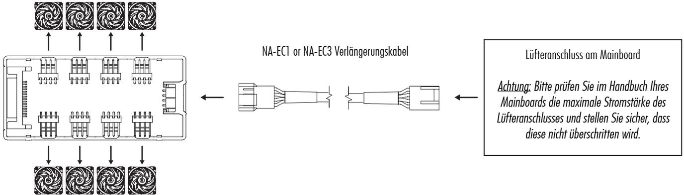
Anwendungsbeispiel 2: Sichere Steuerung von PC-PWM-Lüftern mit hohem Stromverbrauch über einen Mainboard-Lüfteranschluss mit S-ATA-Stromversorgung (max. 54 W)
