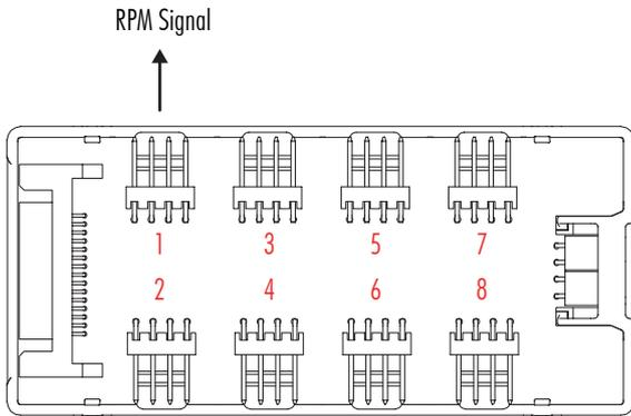
Der NA-FH1 überträgt das Drehzahlsignal des am ersten Anschluss angeschlossenen Lüfters zur Drehzahlüberwachung an das Motherboard. Als zusätzliche Überwachungsfunktion verfügen alle Anschlüsse über Status-LEDs, die bei Empfang eines Drehzahlsignals aufleuchten und bei Stillstand oder Ausfall des Lüfters erlöschen.
