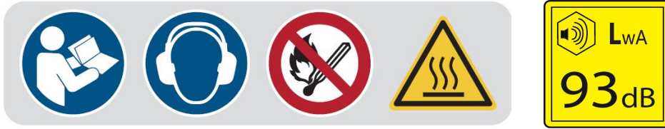
Abb. 1-1: Sicherheitskennzeichnungen PG-D 650 SR (1 Betriebsanleitung beachten / 2 Gehörschutz tragen / 3 Feuer, offenes Licht und Rauchen verboten / 4 Warnung vor heißer Oberfläche), Schalleistungspegel LWA
