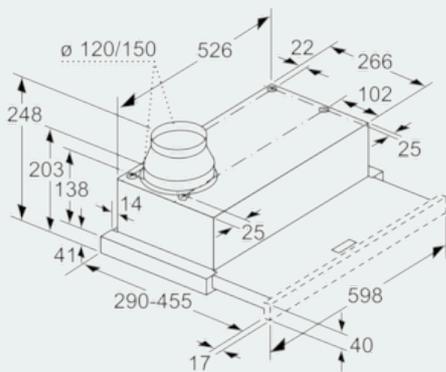
Tiefenanpassung des Filterauszuges bis 29 mm möglich
