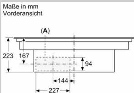
A: Direkt an der Rückseite angeschlossen
