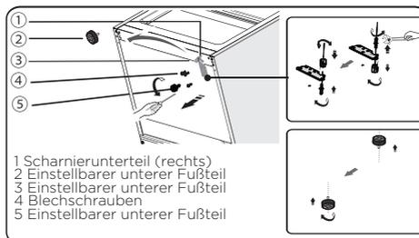
12. Entfernen Sie Teil 3 vom unteren Scharnierstift, lösen Sie den unteren Scharnierstift, setzen Sie ihn in die umgekehrte Position der Bohrung ein und ziehen Sie ihn fest. Montieren Sie dann Teil 3 am unteren Scharnierstift.
