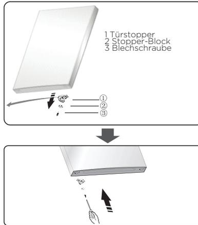
10. Tauschen Sie die Schraubenlochabdeckungen auf der mittleren Abdeckplatte von links nach rechts (siehe Abbildung unten) aus.
