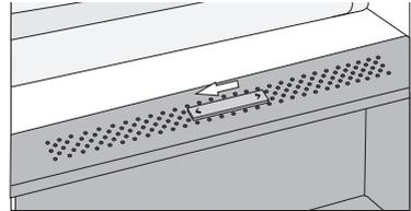
Wenn sich auf der Glasablage Kondenswasser ansammelt, öffnen Sie die Schlitzle und wischen Sie die Ablage trocken
