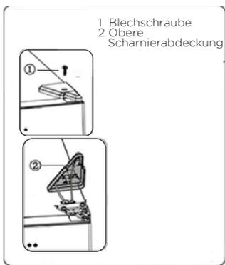
3. Entfernen Sie die Schrauben 1 und das Scharnier 2.
