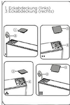
7. Schraube 3 lösen und Teil 2 und Teil 1 abnehmen. Ersatztürstopper links 4 (in der Plastiktüte) und Teil 2 (Stopperblock) mit Schraube 3 links anbringen.
