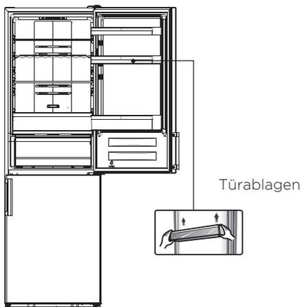
2. Entfernen Sie Teil 1, lösen Sie Teil 2 von der oberen rechten Seite des Kühlschranks.
