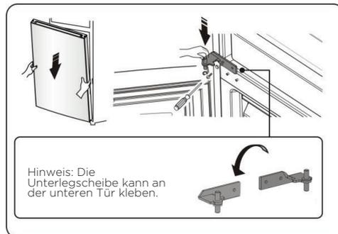
15. Bringen Sie die obere Tür in eine geeignete Position und befestigen Sie dann Teil 2 mit den Schrauben 1.
