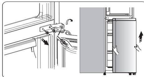
9. Legen Sie die untere Tür mit der Panelseite nach oben auf eine glatte Oberfläche. Schraube 3 lösen und Teil 2 und Teil 1 abnehmen. Montieren Sie den mitgelieferten Ersatztürstopper links 4 (in der Plastiktüte) und Teil 2 (Stopper-Block) mit der Schraube 3 auf die linke Seite. Bewahren Sie Teil 1 zur späteren Referenz auf.
