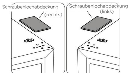
6. Entfernen Sie Teil 1 von der oberen linken Seite der oberen Abdeckung .
