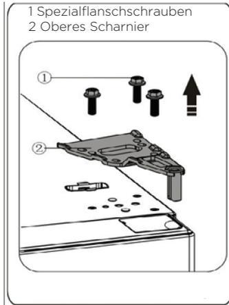
4. Entfernen Sie die obere Tür vom mittleren Scharnier, indem Sie die Tür vorsichtig nach oben anheben. Legen Sie dann die obere Tür mit der oberen Abdeckung nach oben auf eine glatte Oberfläche.
