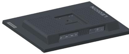
Schritt 4: Bringen Sie die Montagehalterung aus dem VESA-kompatiblen Wandmontageset. (Abstand 100 x 100 mm) an, die Art der VESA-Montageschraube ist M4 x 10 mm.
