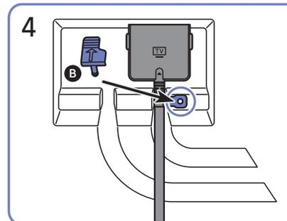
4 Legen Sie den Kabelhalter in das Loch, um die Kabel zu befestigen.
