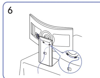
6 Führen Sie die Kabel durch die Kabelführung, um sie ordentlich zu verstauen.
