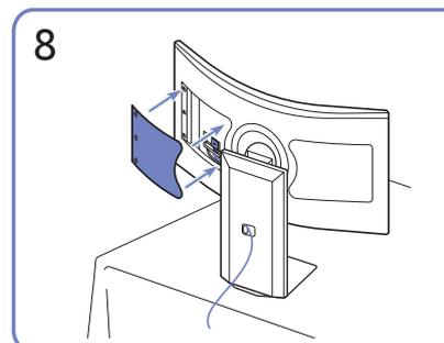
8 Schließen Sie die hintere Abdeckung, um den Vorgang abzuschließen.
