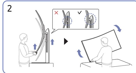
2 Den Standfuß auf seine volle Höhe anheben und dann den Monitor im Uhrzeigersinn drehen, um ihn ins Querformat zu wechseln.
