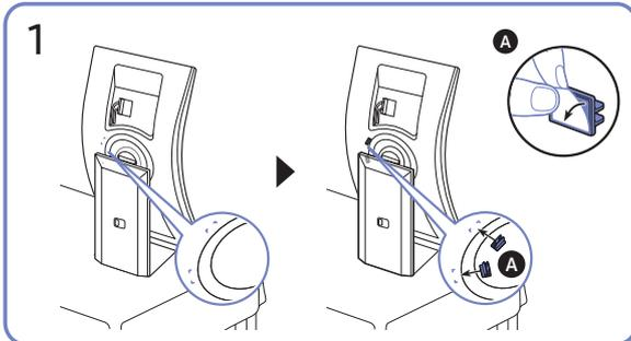
1 Bringen Sie die Kabelführung an der Nut auf der Rückseite des Monitors in an.
