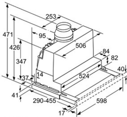
Tiefenanpassung des Filterauszuges bis 29 mm möglich
