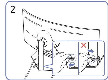
Ziehen Sie an der rechten Seite der STANDFUSSKABEL-HALTERUNG zum Entfernen von dem Standfuß. Die linke Seite des HALTERUNGSTÄNDERKABELS kann beschädigt werden, wenn mit Gewalt daran gezogen wird.
