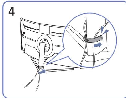
Verlegen Sie beide Kabel wie in der Abbildung gezeigt im Kabelhalter am Standfuß (STANDFUSSKABEL-HALTERUNG), um die Kabel zu organisieren. Die Montage ist abgeschlossen.
