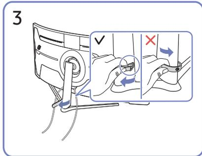
Ziehen Sie an der rechten Seite der STANDFUSSKABEL-HALTERUNG zum Entfernen von dem Standfuß. Die linke Seite des HALTERUNGSTÄNDERKABELS kann beschädigt werden, wenn mit Gewalt daran gezogen wird.
