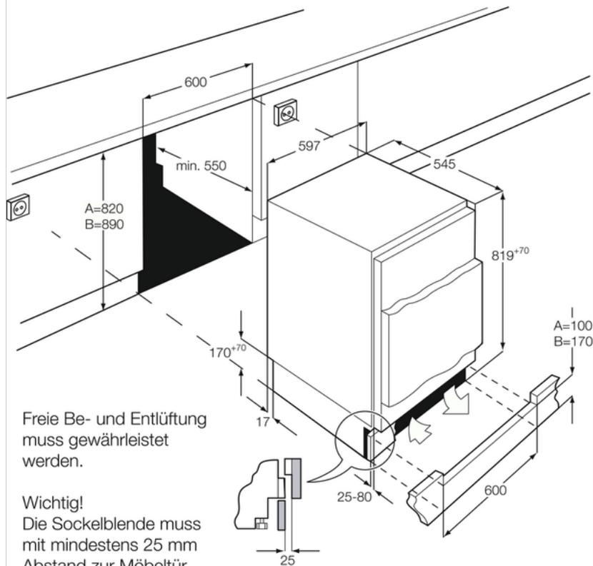
Freie Be- und Entlüftung muss gewährleistet werden.
