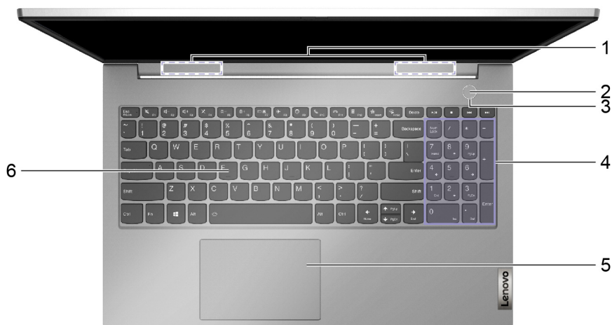
Rysunek 2. Widok podstawy—modele 15-calowe
