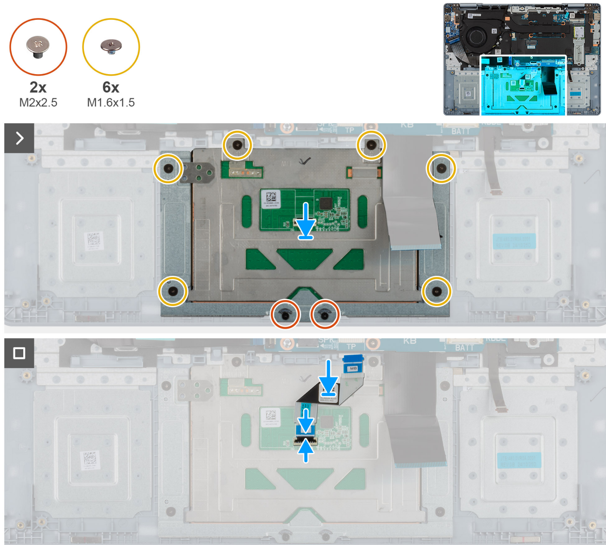
Abbildung 39. Installieren des Touchpads
