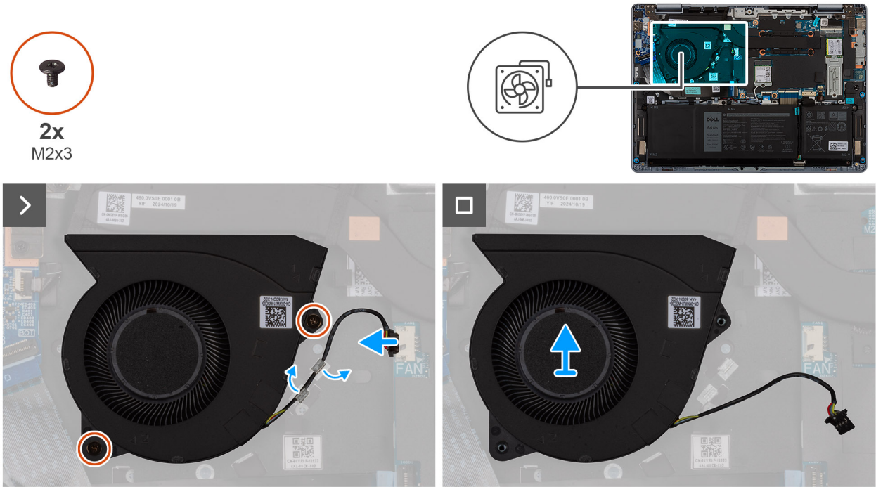
Abbildung 26. Entfernen des Systemlüfters
