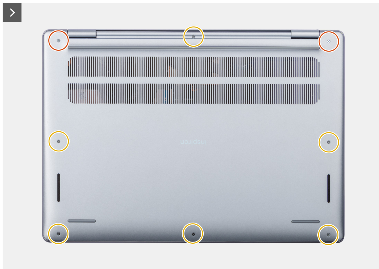
Abbildung 9. Entfernen der Bodenabdeckung
