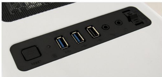
- I/O-Panel mit: 2x USB 3.0-Port, 1x USB 2.0-Port, HD Audio, Lüftersteuerung
