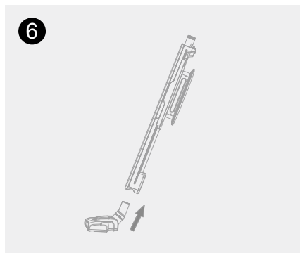
6. Установить половую щетку или пневматическую половую щетку и принадлежности.
