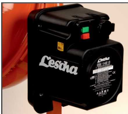
Strahlwassergeschütztes Motorhaus aus schlagfestem Kunststoff mit Schalter-Stecker-Kombination.
